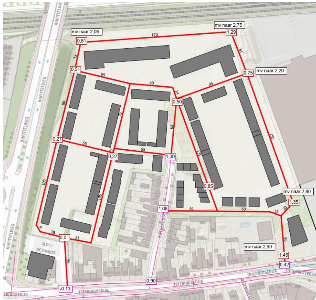
Figuur 4: Schematische diepteligging toekomstig vuilwaterstelsel plangebied bij aansluiting op NAP -0,13 m op hoofdtransportriool in de Teteringsedijk
