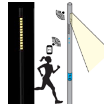
Slimme masten, Selux Line, tracken hardlooprondte, oplaadpunten elektrische auto's, meten gezondste wijk
