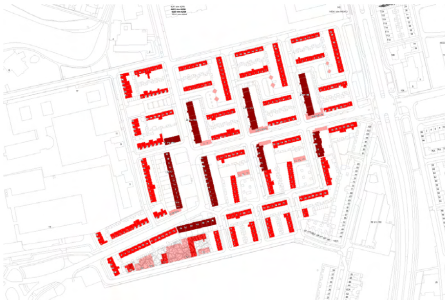
Afb. 5 Tekening waarin de bouwhoogten in het jaren vijftig deel van de wijk zijn weergegeven. Laagbouw (licht) betreft vooral garages en enkele bejaardenwoningen. De gezinswoningen zijn tweelaags, etagewoningen (donkerrood) meerlaags.
