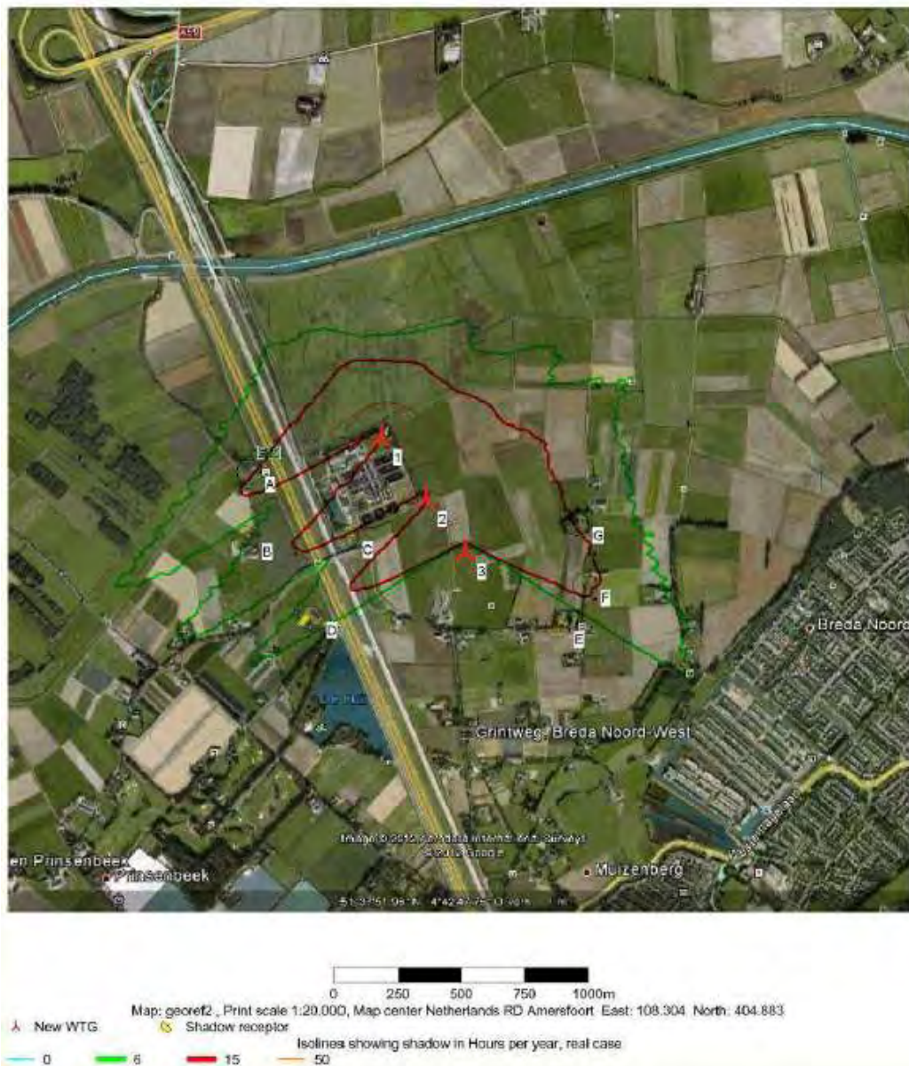
Figuur 5.10 Contouren slagschaduw Nordex [LBP Sight, 2012]
