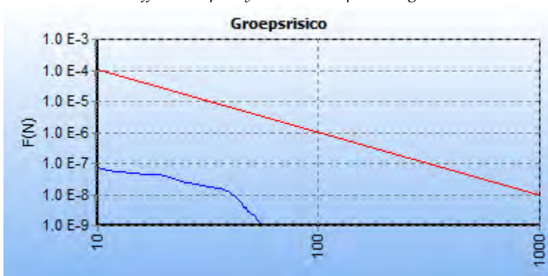
Figuur 7. De fN-curve van de "slechtste" kilometer ten opzichte van de oriëntatiewaarde met op de x-as de hoeveelheid slachtoffers en op de y-as de kans op een ongeval.
