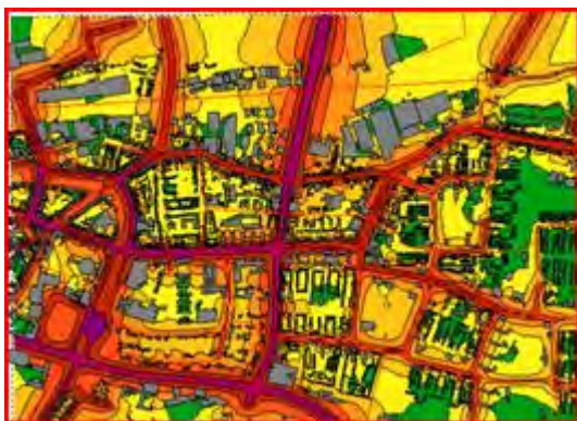
Figuur 5.2 globale geluidbelasting voor relevante wegen voor het jaar 2020 (excl. correcties art 110g Wgh)
