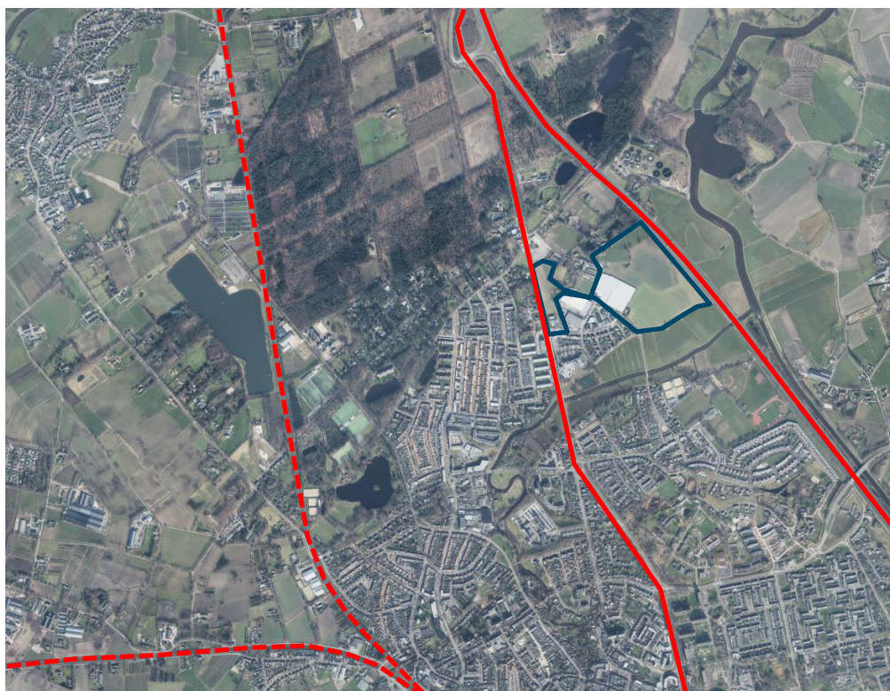
Figuur 3.1: Plangebied (blauw) en relevante risicobronnen: vervoer gevaarlijke stoffen over de weg (rood), vervoer gevaarlijke stoffen over het spoor (rood stippel).
