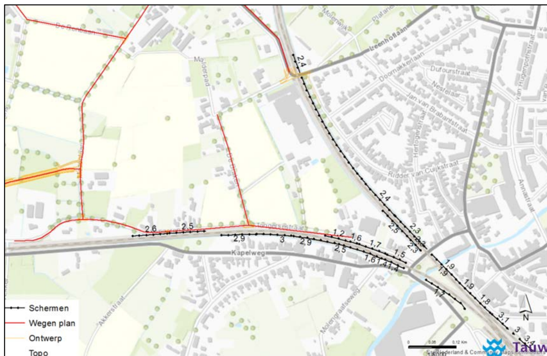
Figuur 3.9 Locatie en hoogte geluidsschermen (hoogte in meters ten opzichte van maaiveld bij de schermen)
