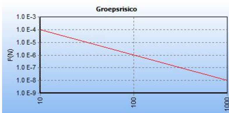
Afbeelding 6 fN-curve buisleiding A-525-deel-1, huidige situatie
