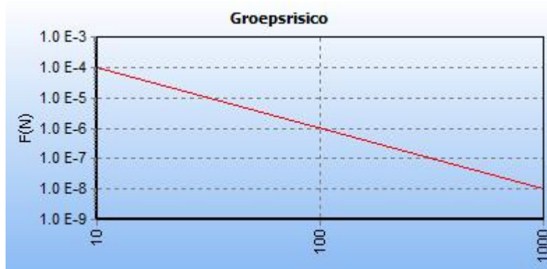
Afbeelding 11 fN-curve buisleiding A-526-deel-1, huidige situatie
