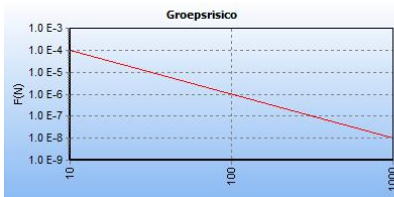
Afbeelding 16 fN-curve buisleiding A-527-deel-1, huidige situatie
