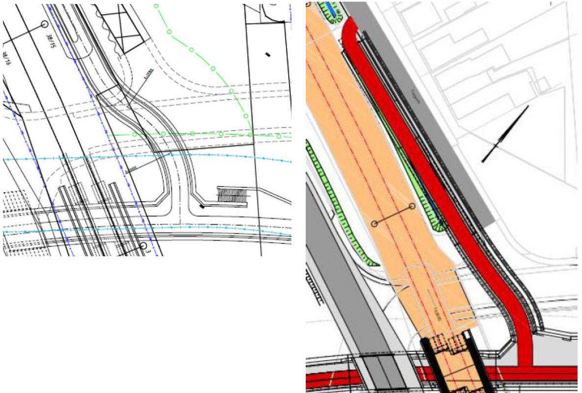
Figuur 7. Aansluiting voor voetgangers met trap (links) of hellingbaan (rechts).
