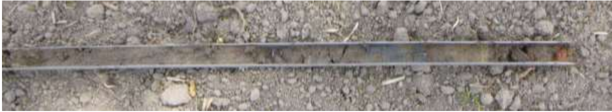
Figuur 5: Foto van het sterk vergraven zandpakket met slooppuin zoals dat nagenoeg overal is aangetroffen.
