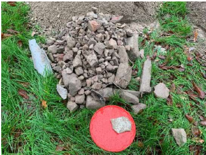
Foto 11: Bodemvreemd materiaal PS04 (met op de rode deksel het asbest plaatmateriaal)
