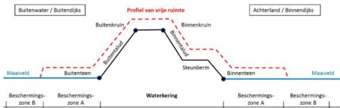
1. Figuur 15.2: Principe van leggerprofiel en bijbehorende zones en profiel van vrije ruimte
