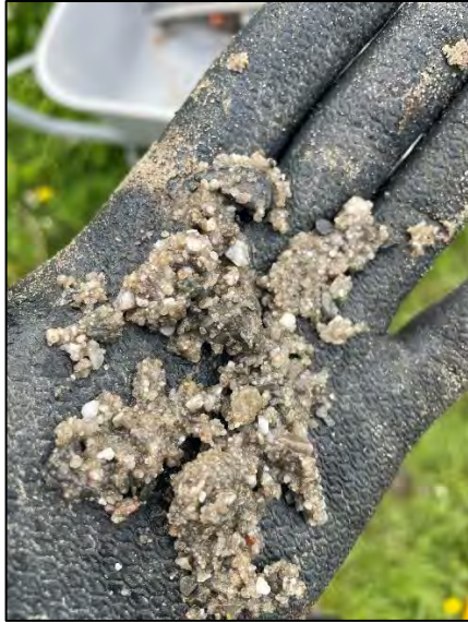
foto's 9 en 10: boring 03 (links grof zand van boring 03)
