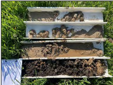
foto's 5 en 6: boring 01 (rechts stoorlaagje 1,4 – 1,5 m-mv)
