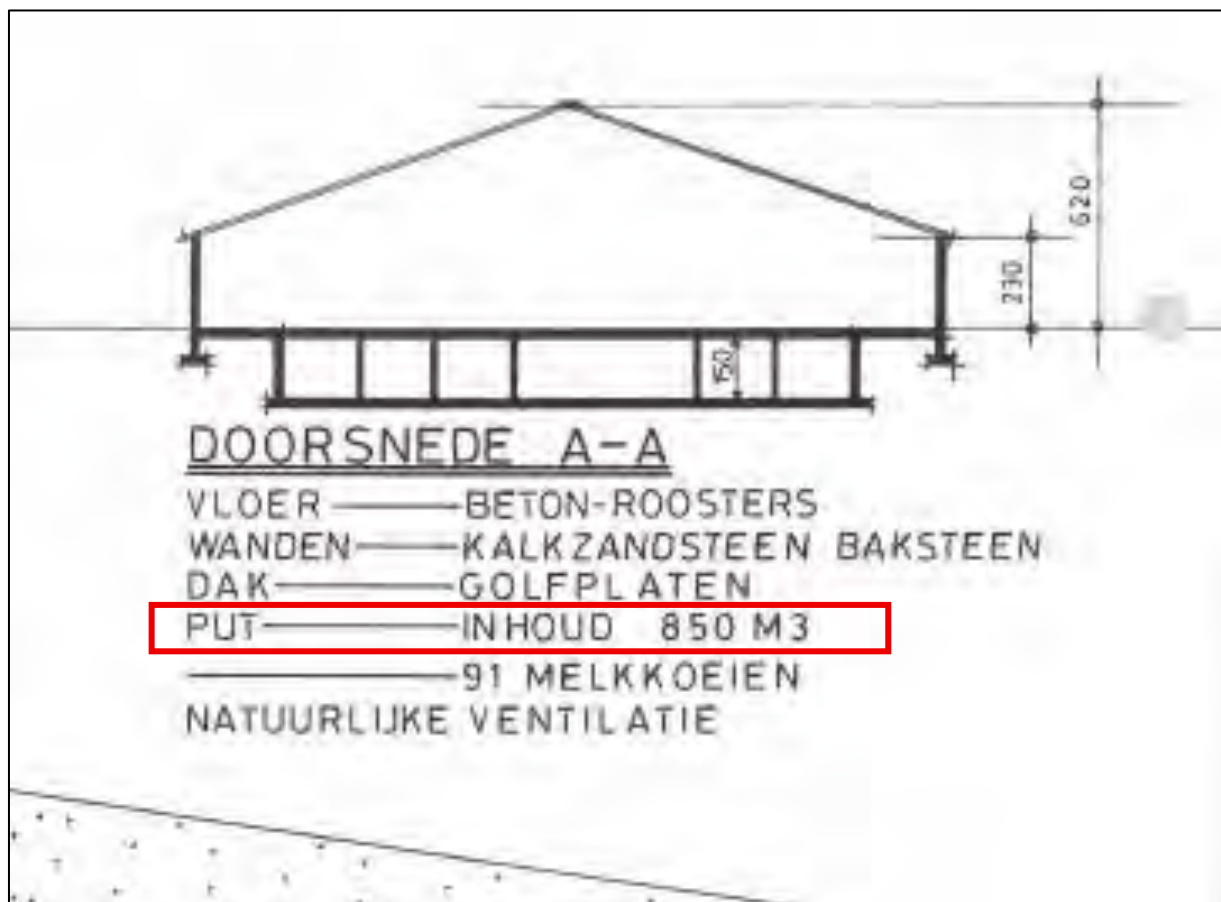
Afbeelding 2 Doorsnede te saneren melkveestal
