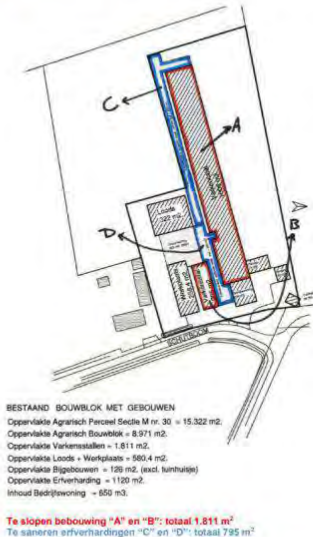
Figuur 37 Te slopen en saneren onderdelen
