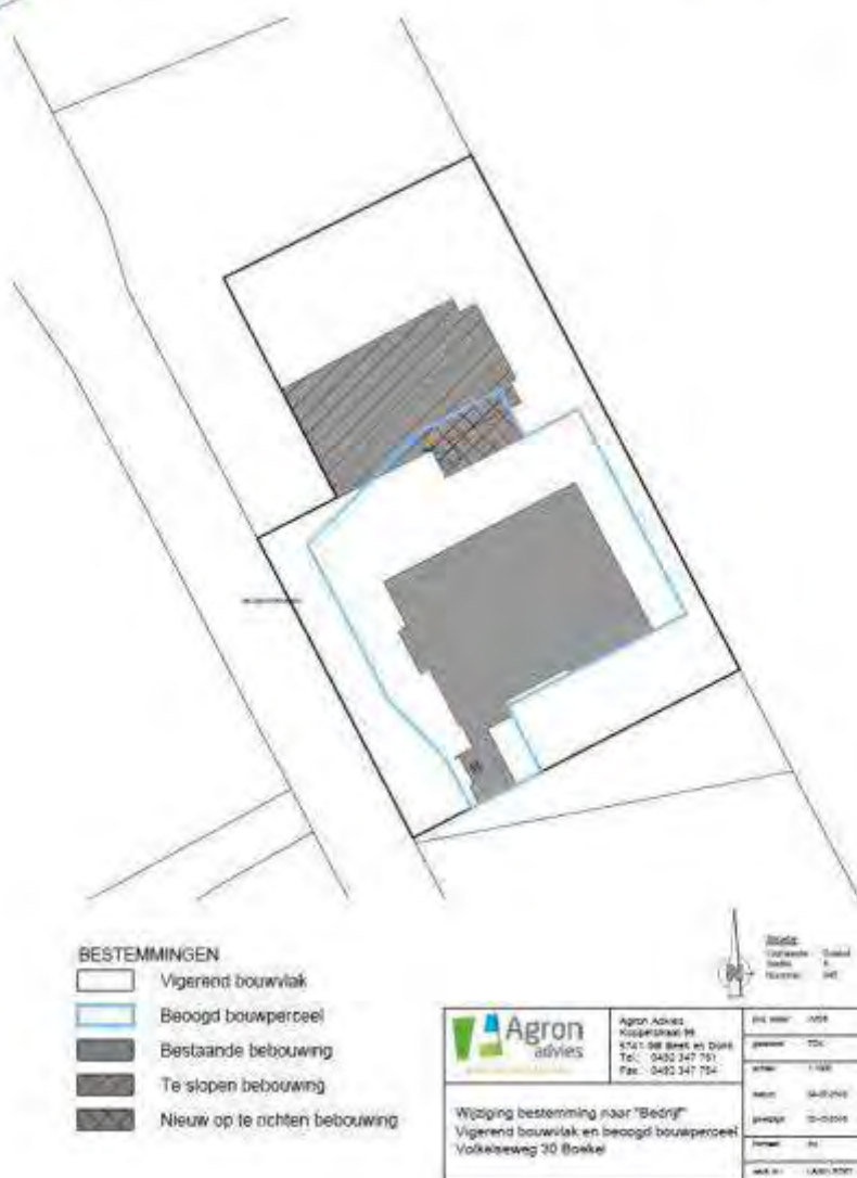
Figuur 43 Te slopen en saneren onderdelen
