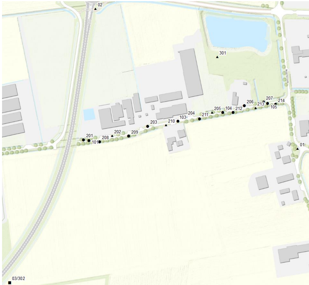
Figuur 2-4: locaties van de boringen (boordiepte: cirkel 1,0 m -mv; vierkant 3,0 m -mv; driehoek 4,0 m -mv.
