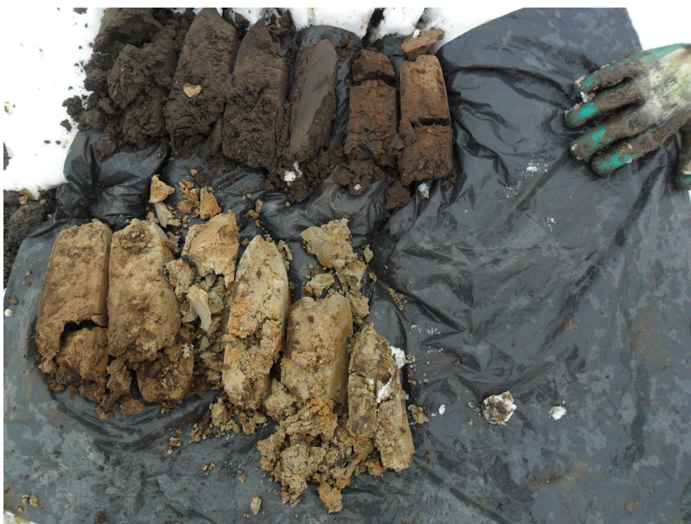
Opname van boring 7. Er zijn in de top van het dekzand nog resten van een inspoelingshorizont aanwezig.
