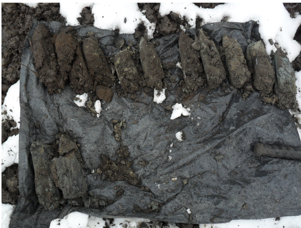
Opname van boring 4. Een volledig omgewerkte bodem.
