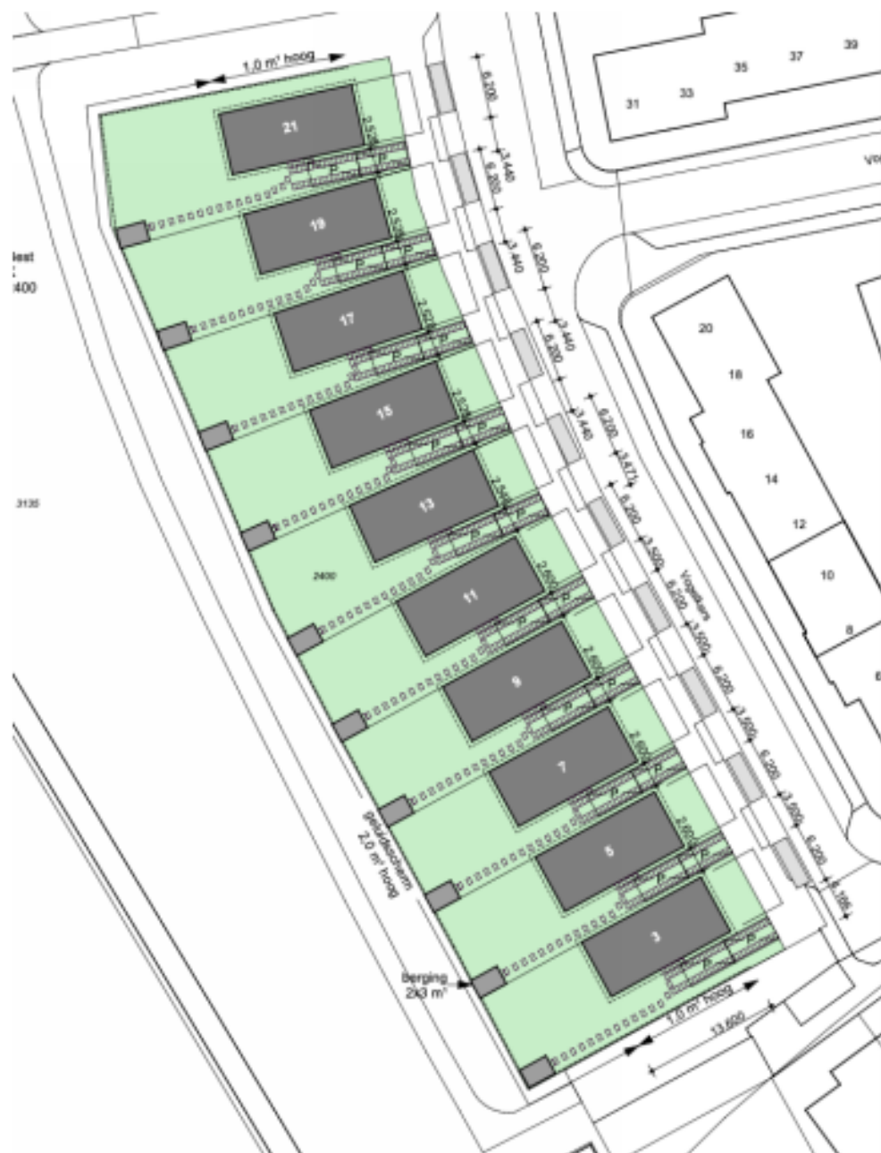
Figuur 4: Locatie en hoogten van het geplande Kokowall Lite geluidscherm.
