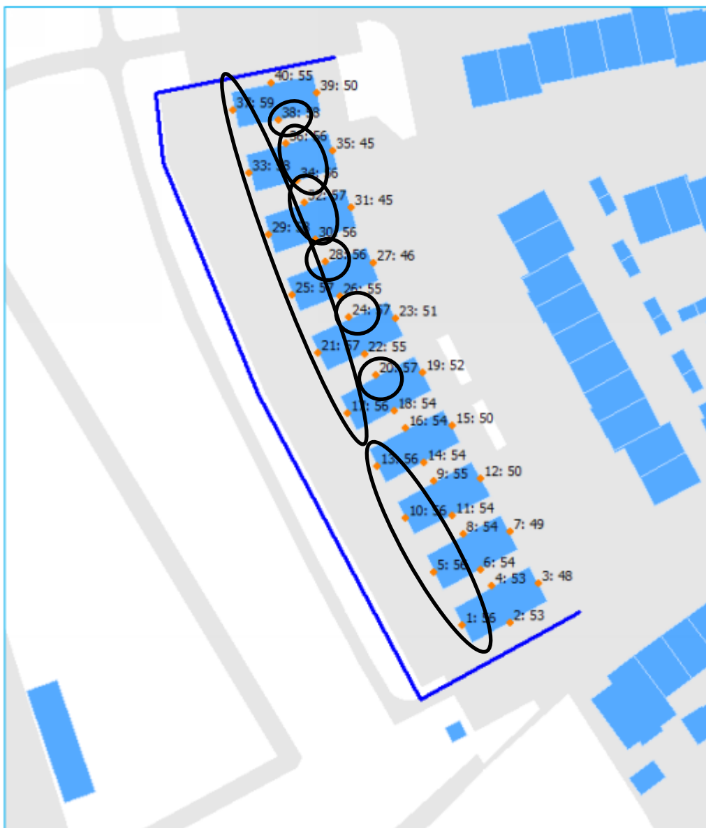
Figuur 8: Geluidbelasting in dB ten gevolge van het spoorweglawaai
