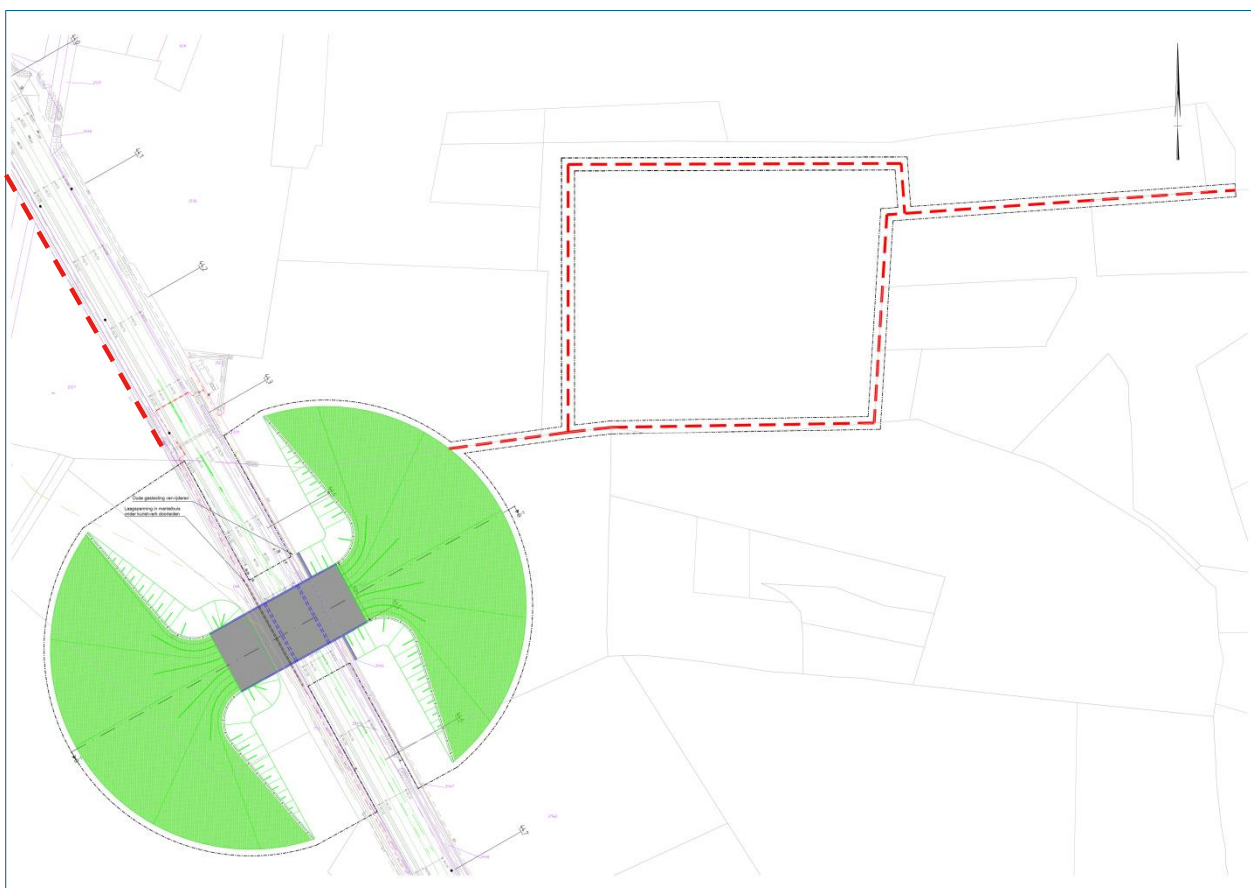
Figuur 3.5: Werkterrein (in groen) en ontsluitingsroutes (in rood gestreepte lijnen) voor de natuurbrug De Mortelen. (Railinfra Solutions, 2014).
