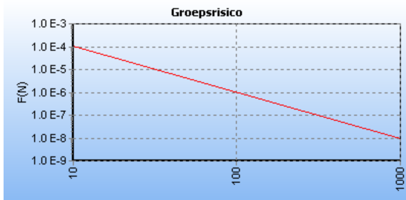
5.4 Figuur 5.4 FN curve voor Z-510-28 van N.V. Nederlandse Gasunie voor de kilometer tussen stationing 0.00 en stationing 1000.00
