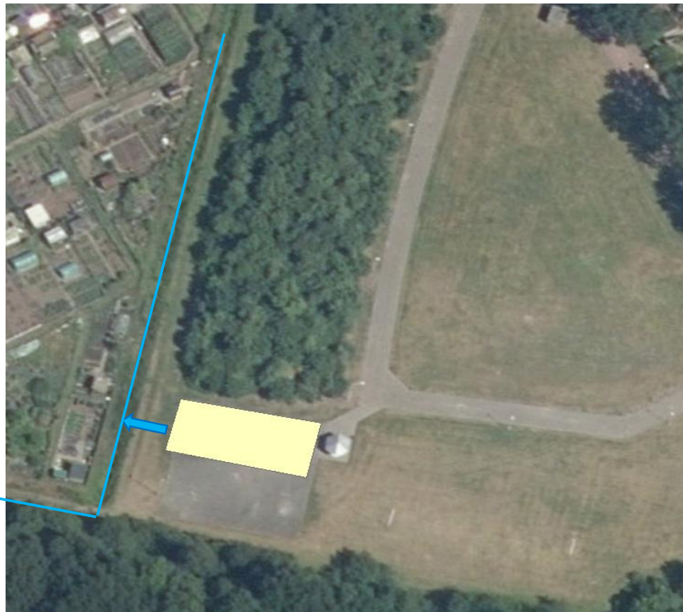
Figuur 4 Indicatief ruimtebeslag waterberging (10x25m) en overstort richting watergang ten westen. Water stroomt oppervlakkig via de weg richting de bergingsvoorziening.
