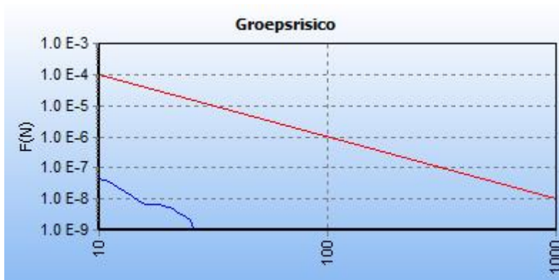
Afbeelding 7 fN-curve buisleiding A-525-02-deel-1, toekomstige situatie
