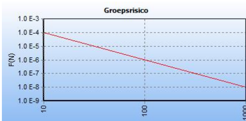
Afbeelding 11 fN-curve buisleiding Z-510-28-deel-1, huidige situatie
