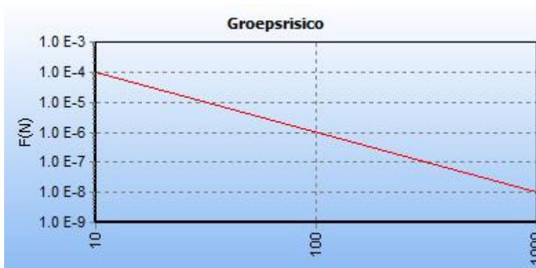
Afbeelding 12 fN-curve buisleiding Z-510-28-deel-1, toekomstige situatie
