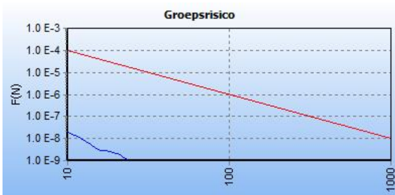
Afbeelding 6 fN-curve buisleiding A-525-02-deel-1, huidige situatie
