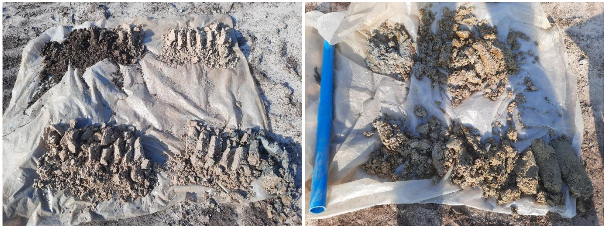
Afbeelding 2: Boorprofiel van boorpunt D uitgelegd van linksboven naar rechtsonder.
