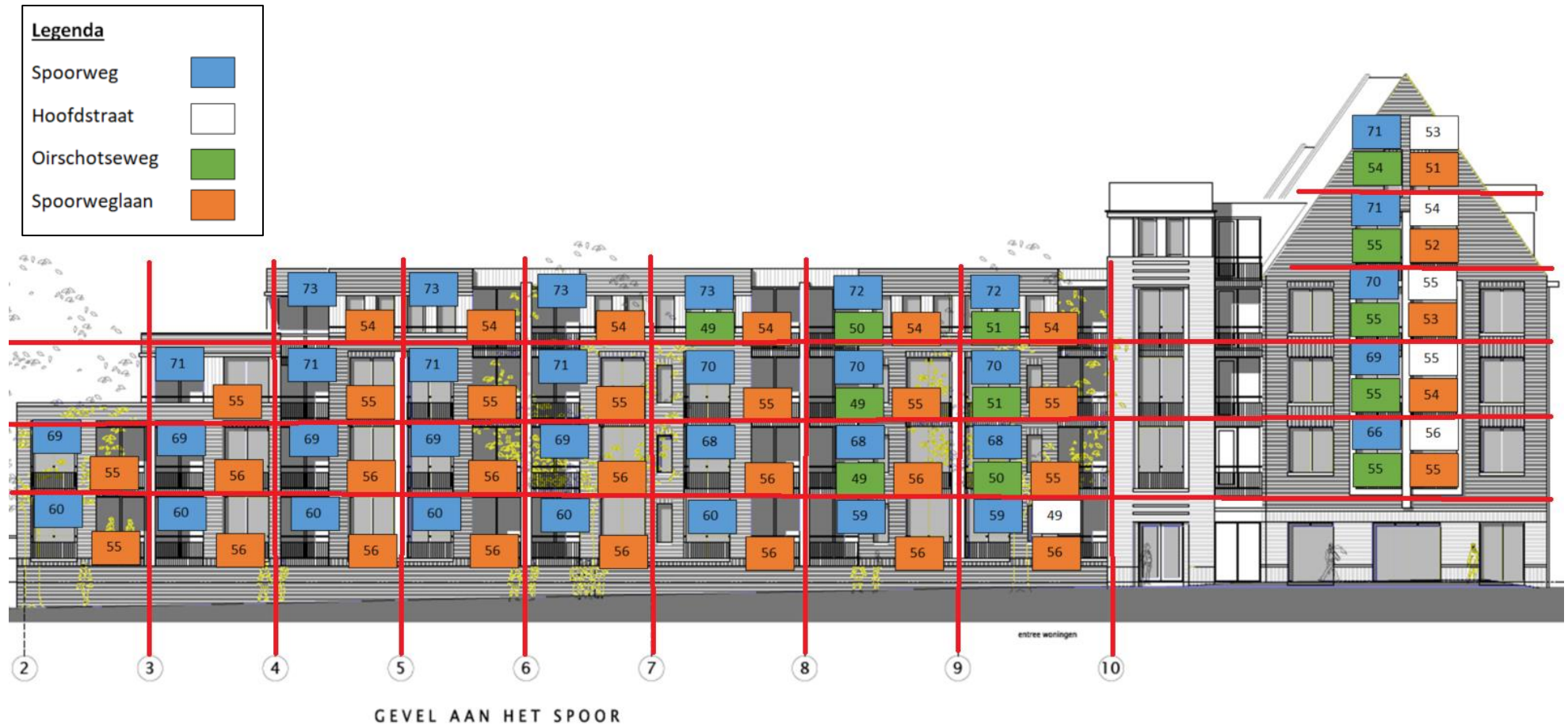
Figuur 4.1 Geluidsbelastingen per appartement aan de spoorzijde
