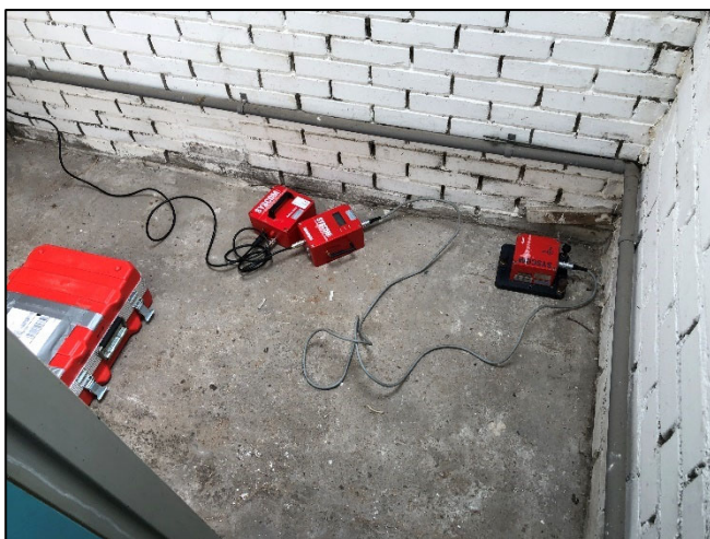
Figuur 3.3: Meetopstelling in gebouw achter het restaurant op meetpunt "fundering"
