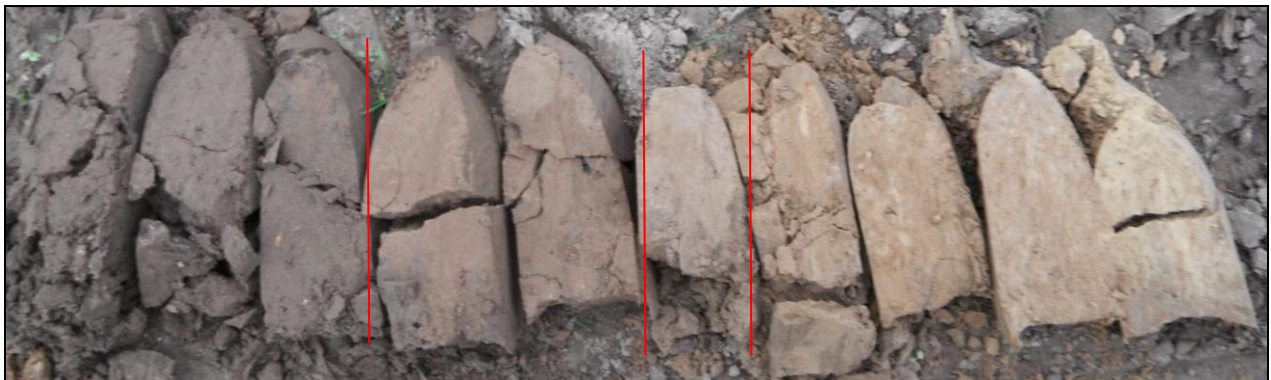
Figuur 6: boring 1 met Ap1-, Ap2-, Oa- en C-horizont
