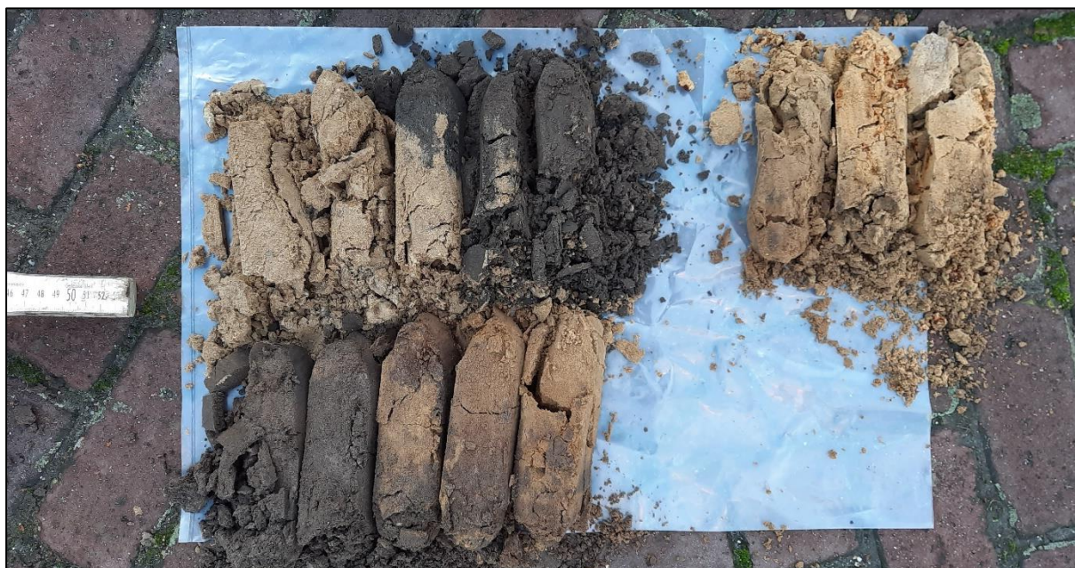
Boring 3: 0-130 cm -Mv. De foto moet worden gelezen van linksboven (maaiveld) naar linksonder naar rechtsboven (C-horizont).
