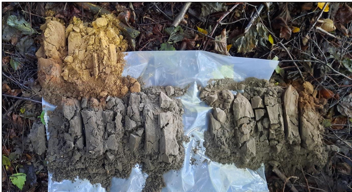
Boring 1: 0-130 cm -Mv. De foto moet worden gelezen van linksonder (maaiveld) naar rechtsboven (C-horizont).
