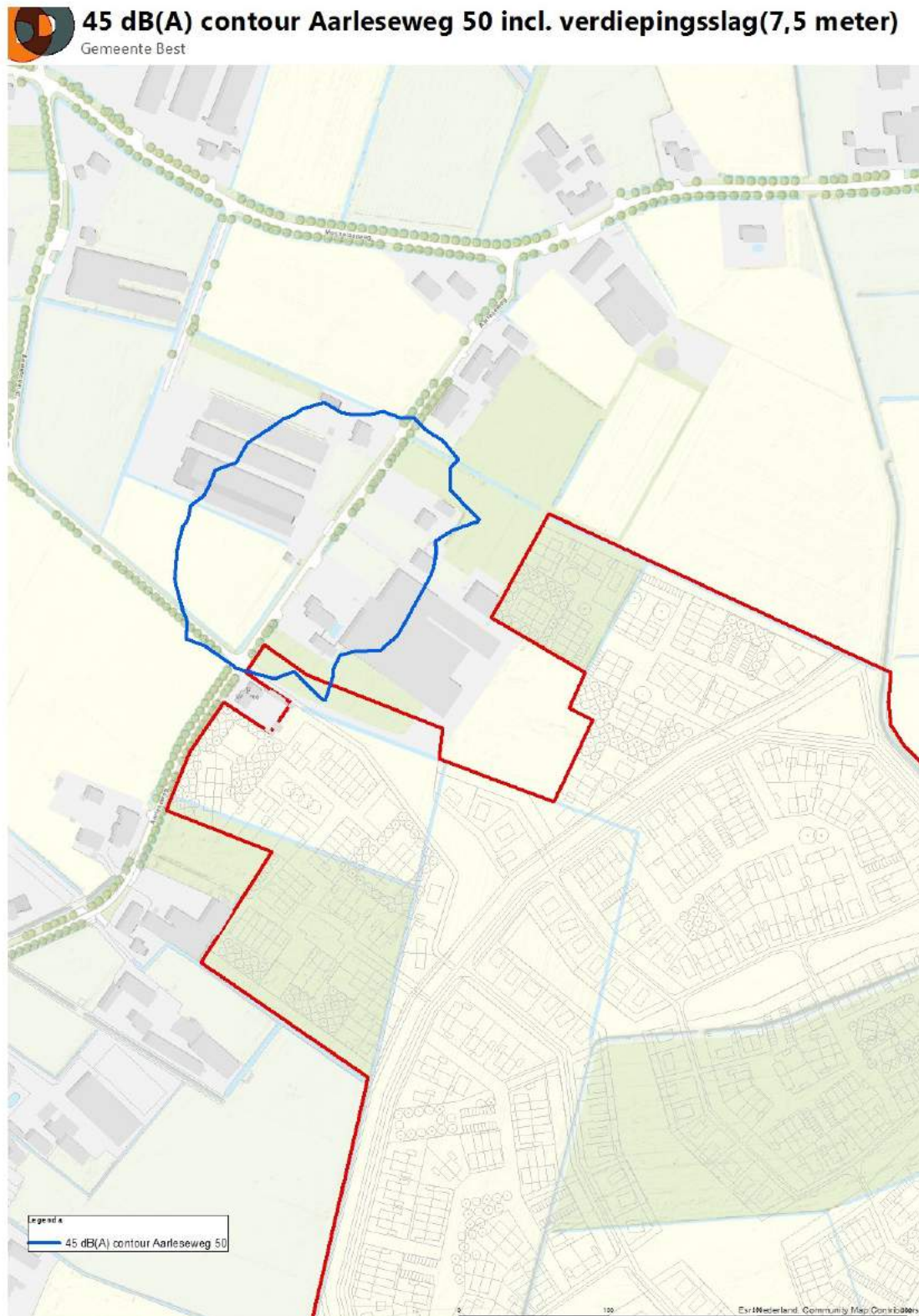
Figuur 11: Verdiepingsslag Aarleseweg 50 op 7,5 m hoogte
