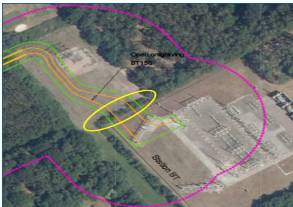
Figuur 3.4: Locatie open ontgraving station Best (Open ontgraving BT 150). Geel omcirkeld het gedeelte van de open ontgraving (oranje lijnen zonder gele contour), welke door houtopstanden lijkt te gaan.
