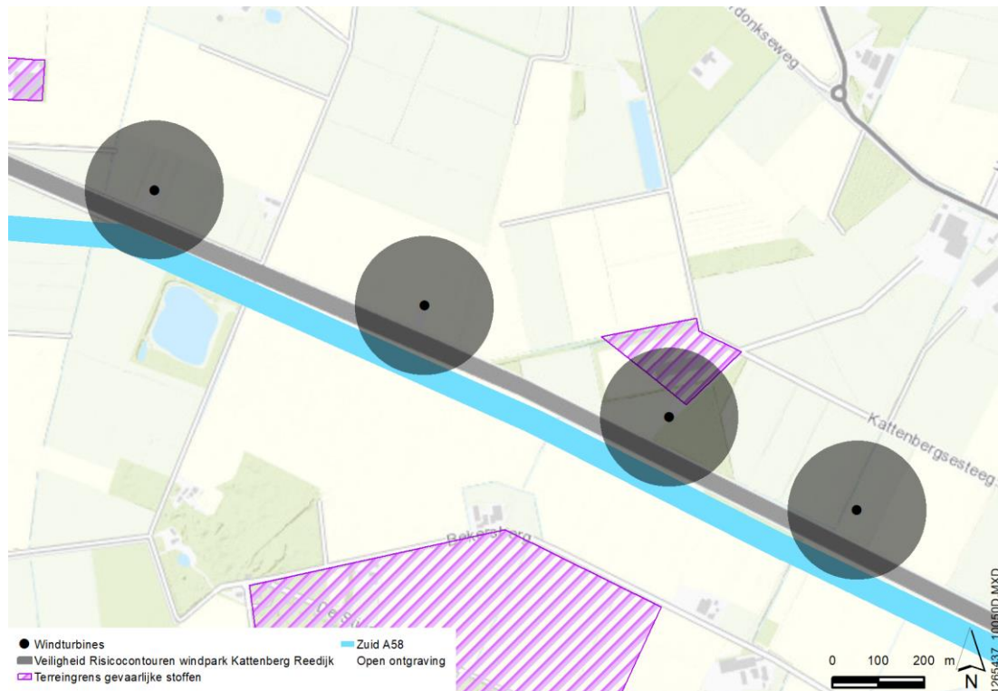
Afbeelding 7.1 Overlappende risicocontouren windpark Kattenberg Reedijk tracé Zuid A58
