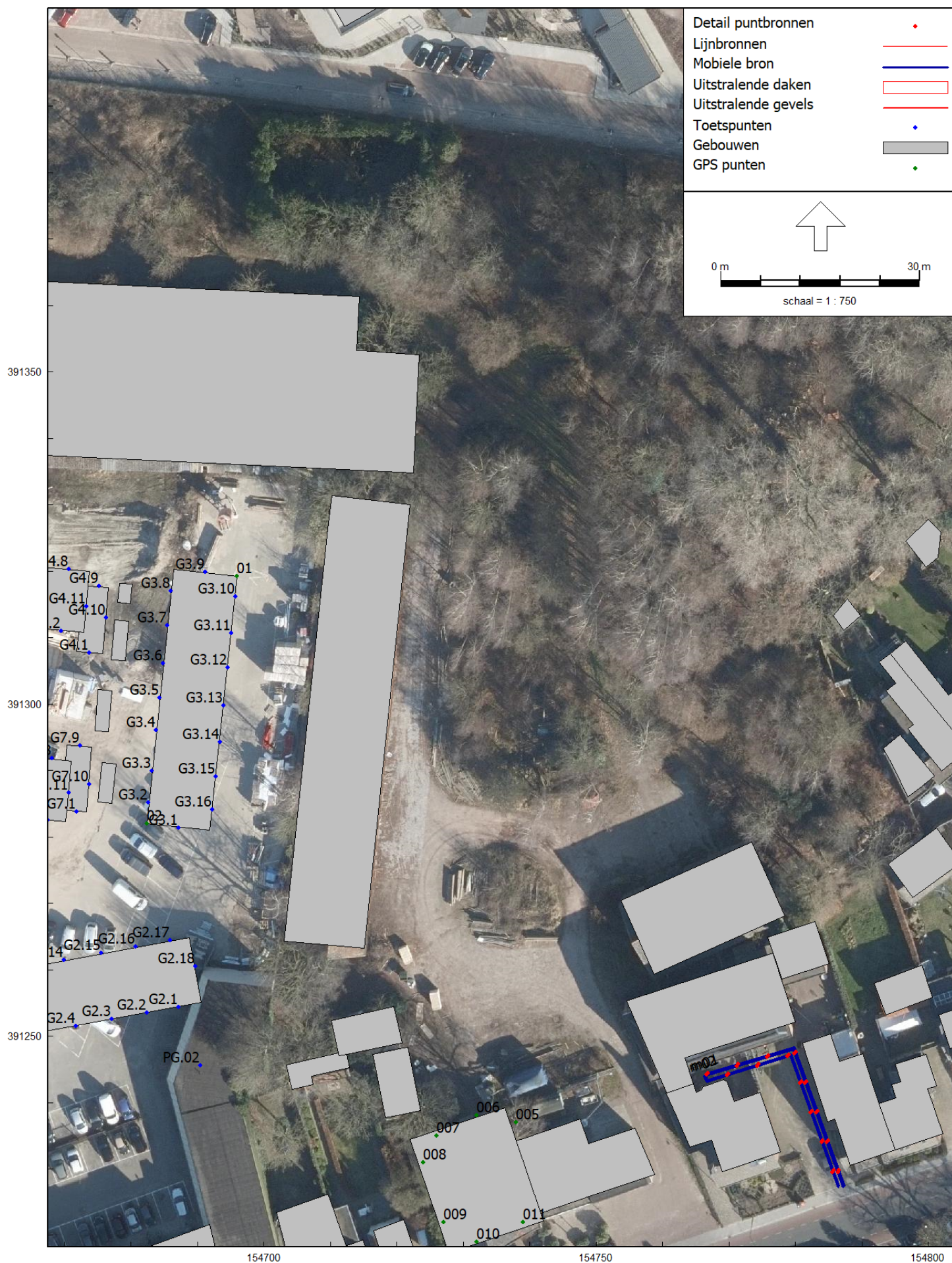
Figuur 2b: Grafische weergave rekenmodel: bronnen LMax - Van Grinsven
