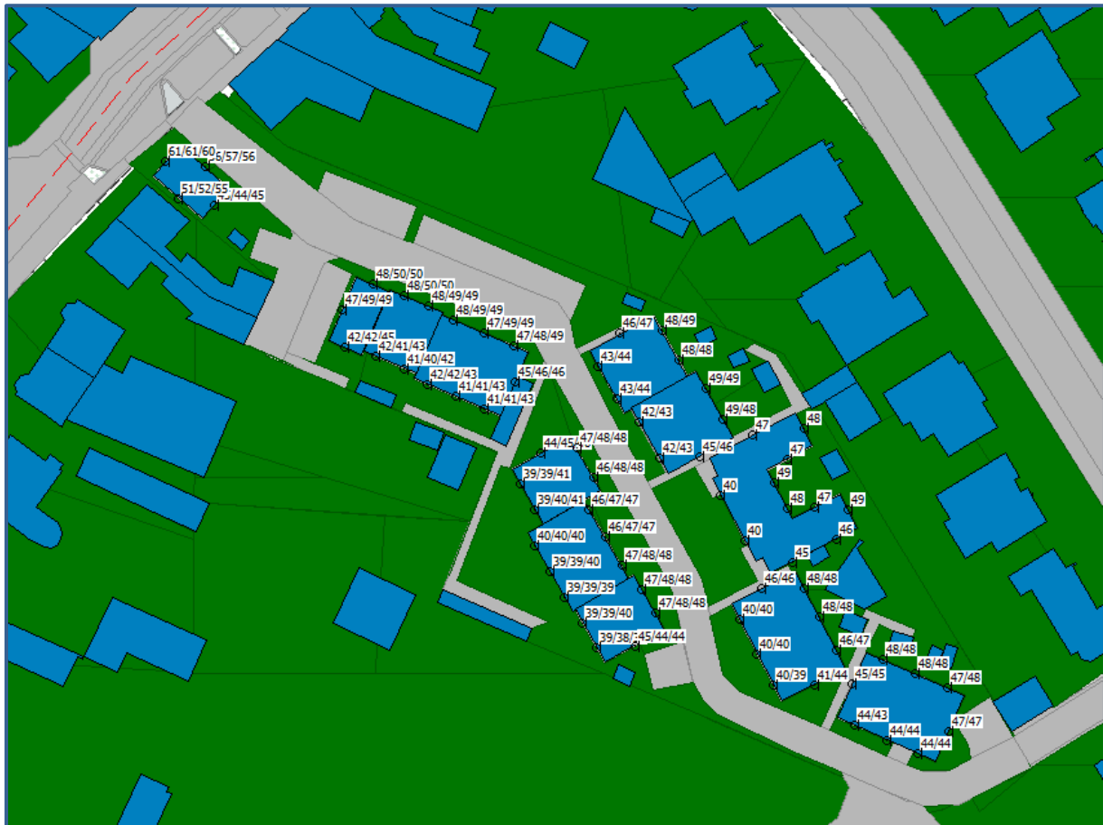
Afbeelding 8. Geluid L_{den} cumulatief wegverkeer Berekend geluid op een hoogte van 2,0 ; 5,0 en 8,0 meter
