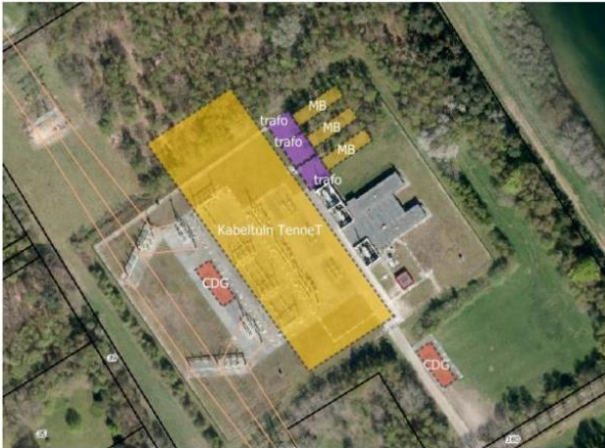
Figuur 3 Voorgenomen werkzaamheden voor hoogspanningsstation Best met uitbreiding van Enxex en TenneT.
