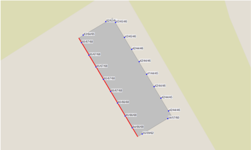
Figuur 5.3 gevel waar aanvullende maatregelen benodigd zijn om deze geluidluf te maken (rode gevel).
