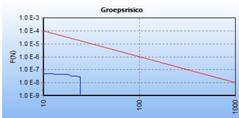
5.2 Figuur 5.2 FN curve voor 9125_leiding-A-671-deel-1 van N.V. Nederlandse Gasunie voor de kilometer tussen stationing 640.00 en stationing 1640.00
