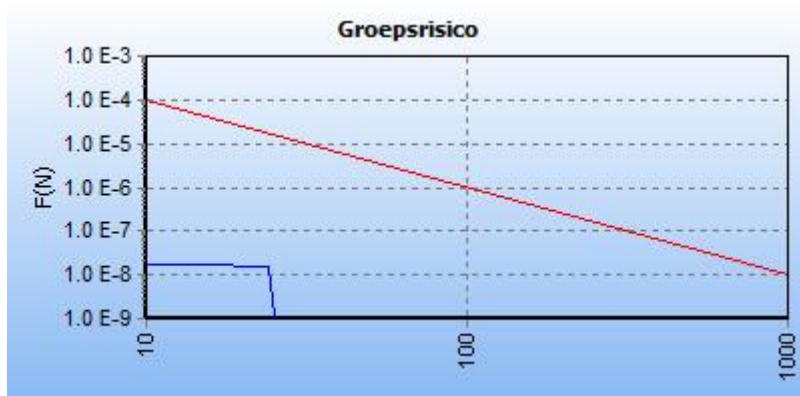
5.2 Figuur 5.2 FN curve voor 9125_leiding-A-671-deel-1 van N.V. Nederlandse Gasunie voor de kilometer tussen stationing 640.00 en stationing 1640.00
