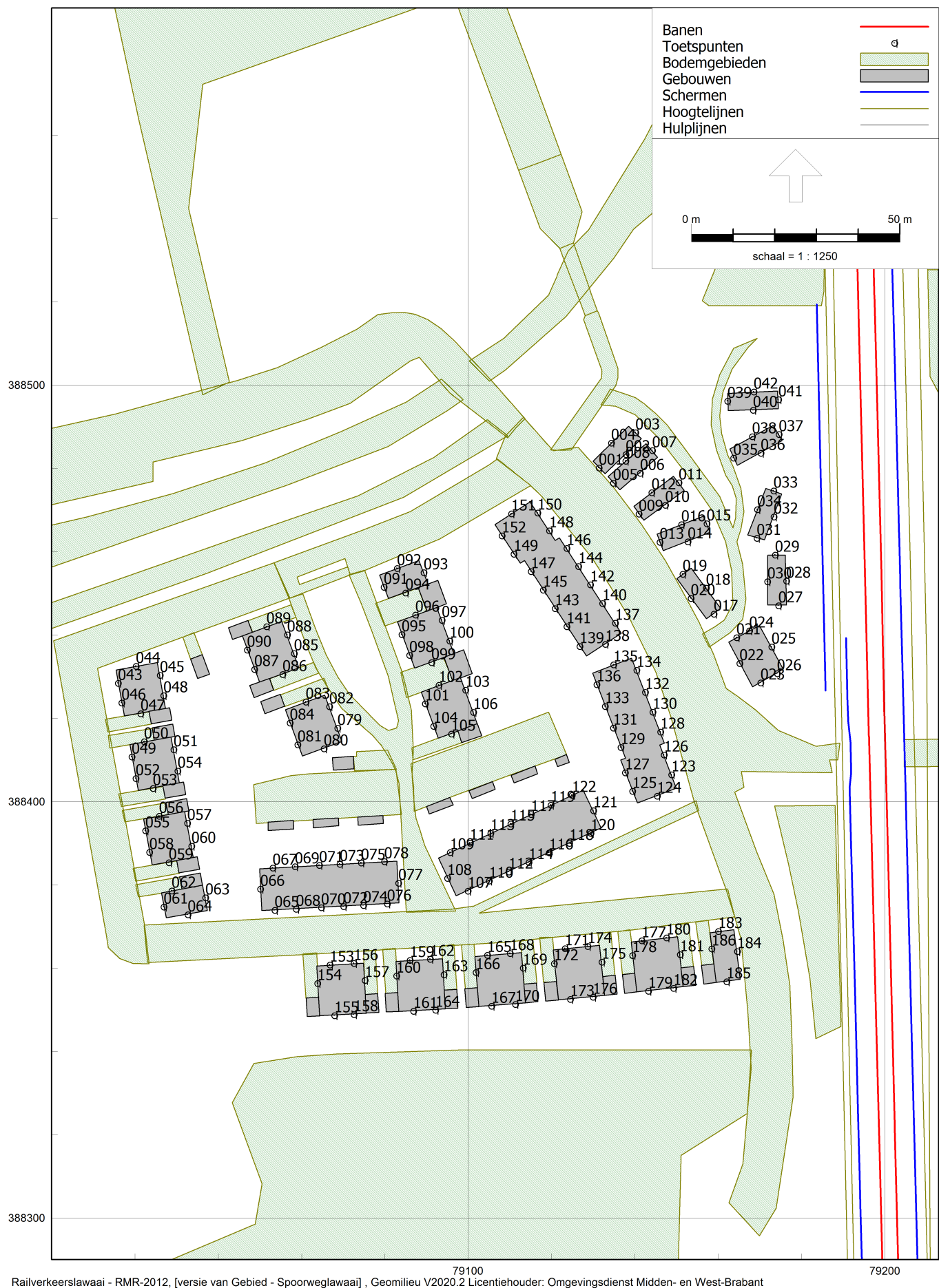
Overzicht computermodel spoorweglawaaai met ligging berekeningspunten
