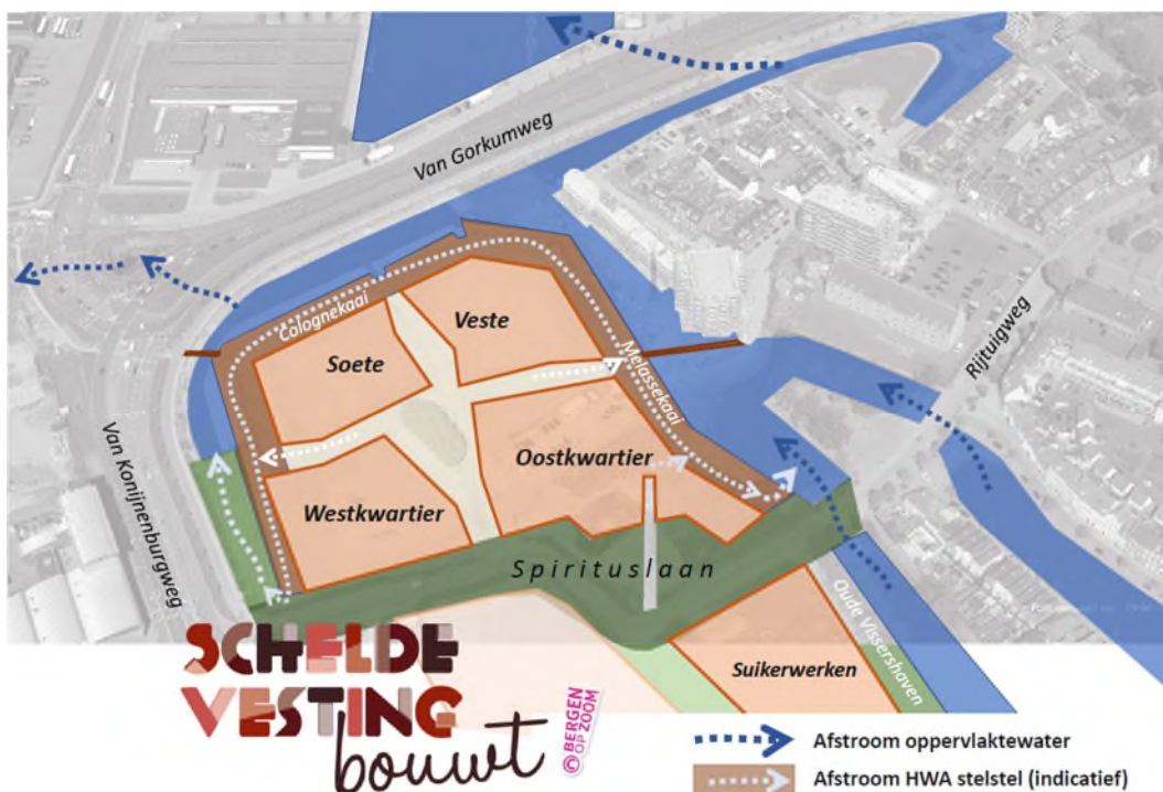
Figuur 10. Watersysteem fase 2 Nieuwe Vesting
