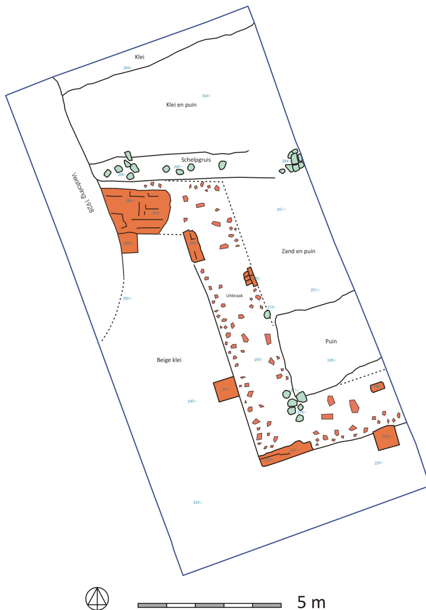
Afb. 15. Het vlak in coupure 2 met de funderingsresten van de frontmuur en resten van bestrating.
