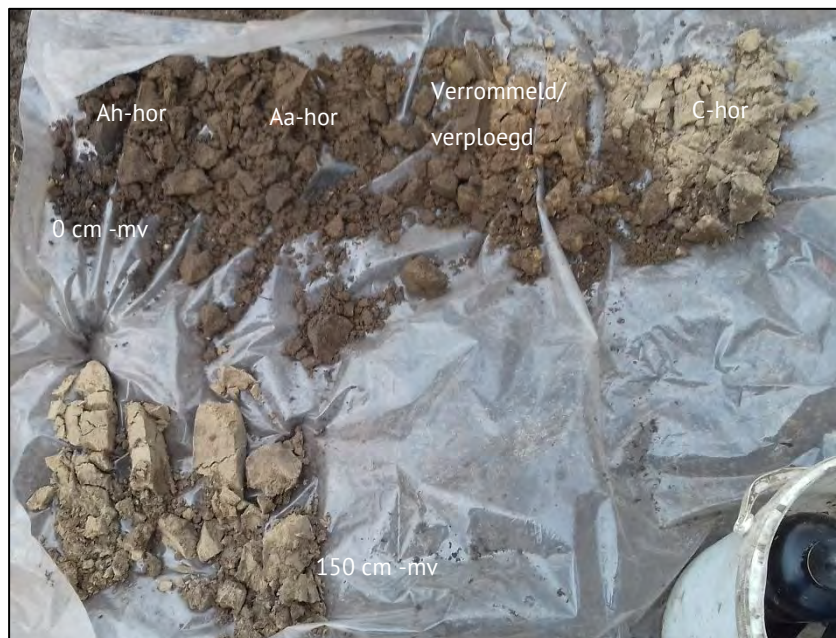
Figuur 9: Foto boorprofiel van boring 6. Leesrichting is van linksboven naar rechtsonder (0 – 150 centimeter): matig humeuze donker bruingrijze A-horizont die via een verrommeld pakket over gaat naar de grijsbeige C-horizont.
