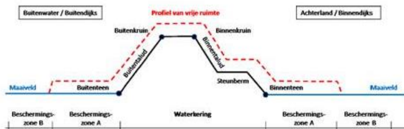
Figuur 15.2: Principe van leggerprofiel en bijbehorende zones en profiel van vrije ruimte
