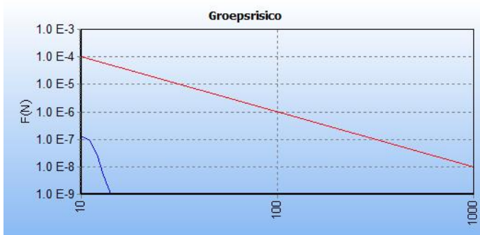
Figuur 14: fN-curve van de kilometer met de hoogste overschrijdingsfactor van gastransportleiding Z-525-02 in de huidige situatie. De ligging van deze kilometer is hiernaast in het groen weergegeven op een topografische kaart.
