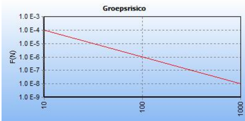
Figuur 16: fN-curve van de kilometer met de hoogste overschrijdingsfactor van gastransportleiding Z-525-03 in de huidige situatie. De figuur geeft weer dat er geen groepsrisico berekend kan worden.
