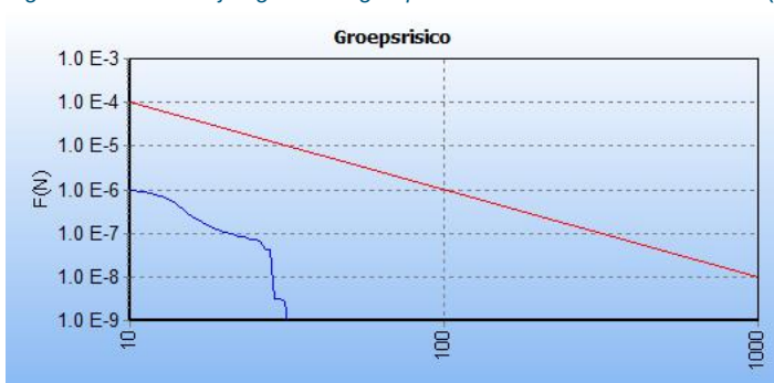
Figuur 18: fN-curve van de kilometer met de hoogste overschrijdingsfactor van gastransportleiding Z-525-01 in de huidige situatie. De ligging van deze kilometer is hiernaast in het groen weergegeven op een topografische kaart.
