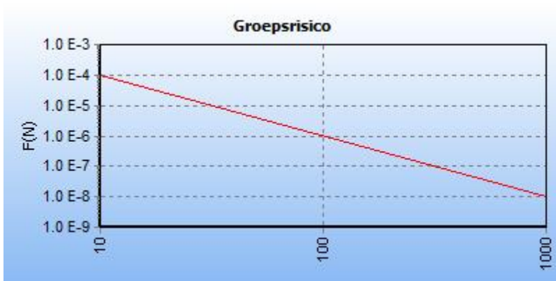
Figuur 20: fN-curve van de kilometer met de hoogste overschrijdingsfactor van gastransportleiding Z-525-03 in de toekomstige situatie. De figuur geeft weer dat er geen groepsrisico berekend kan worden.
