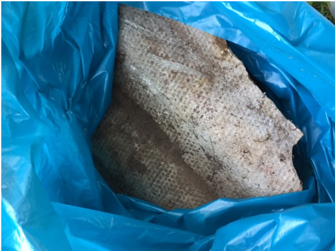
Foto 2: Asbestverdachte golfplaten uit sleuf SL001
