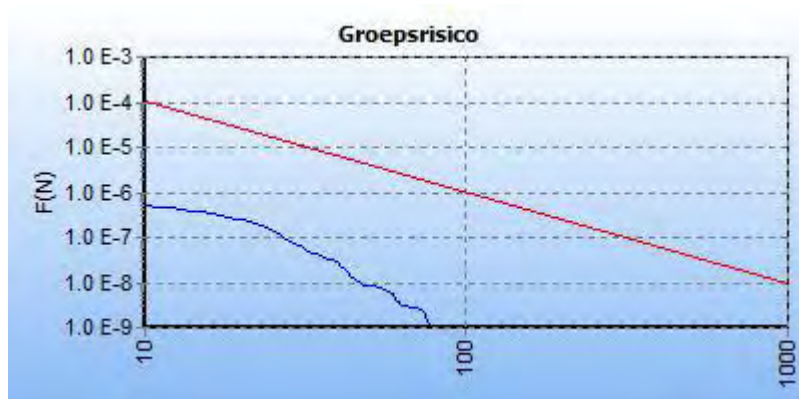
Figuur 5.3 FN curve voor A503 nieuwe situatie (tussen stationing 57260.00 en stationing 58260.00)
