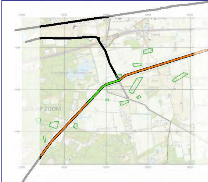
Figuur 4.4 Kilometer leiding behorende bij de maximale overschrijding van de FN-curve voor A503
