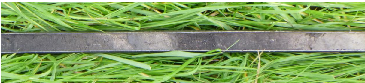
Figuur 23: Foto van boring 4 met geheel links venig zand en links van het midden een dun laagje beekklei ingebed in geelgrijs zand met rechts daarvan een laagje veen dat via een laag venig zand overgaat in het schone geelgrijze zand van de C-horizont.
