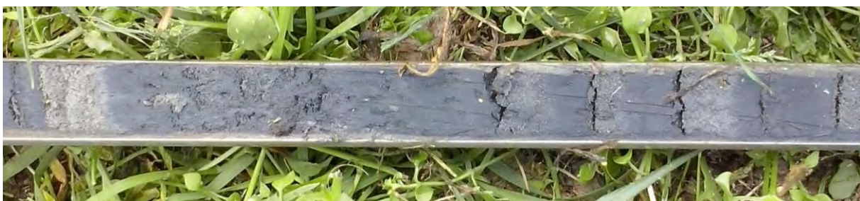
Figuur 18: Door zandlaagjes onderbroken klei zoals deze in boring 8 is aangetroffen
