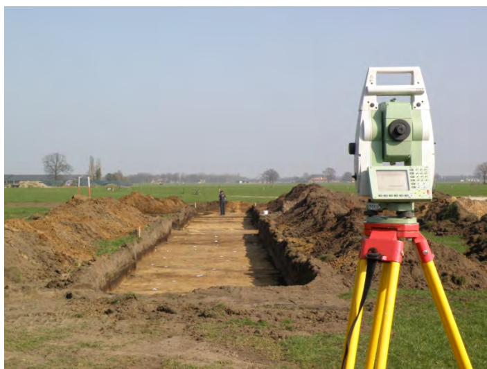
Afb. 2.2. Het inmeten van de grondsporen met behulp van een robotic Total Station.
