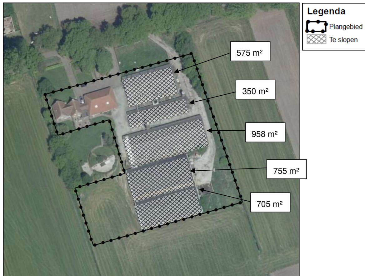
Figuur 9: Te slopen bebouwing
