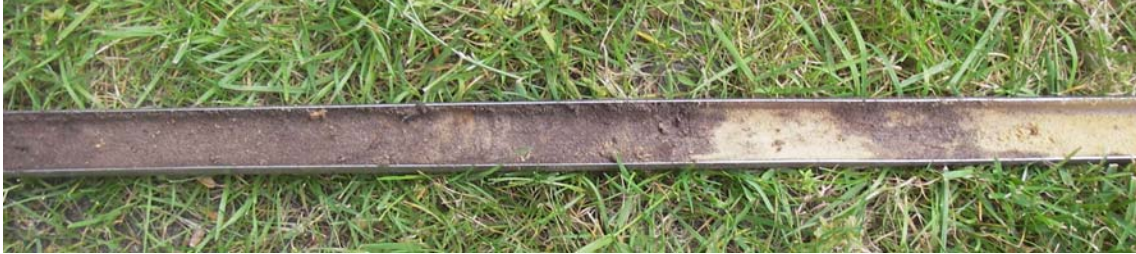
Figuur 16: Foto van de kenmerkende bodemopbouw binnen de beide delen van het plangebied zoals deze is aangetroffen op de boorpunten 1, 3, 8, 9, 11 en 12.
