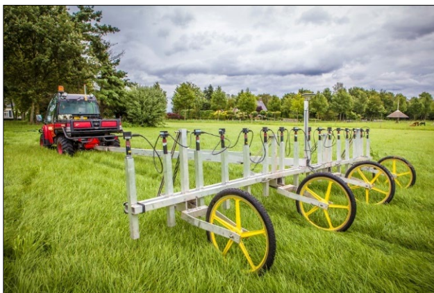
Figuur 3. Passieve non realtime oppervlakedetectie met het Vallon Multisondesysteem VXV16 en een staafdiagram waarop het maximale detectiebereik (m² – maaiveld) per kaliber is weergegeven.
